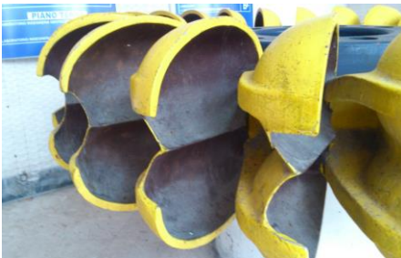
Si vede la sagomatura interna della piastra (pala). Le pale si susseguono con la rotazione
