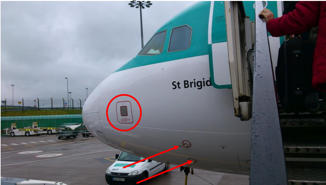
1 le frecce indicano le prese dinamiche, il cerchio la presa statica
